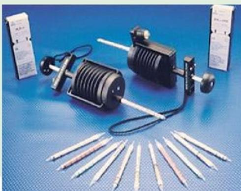
Bomba para mediciones fosforo de aluminio
